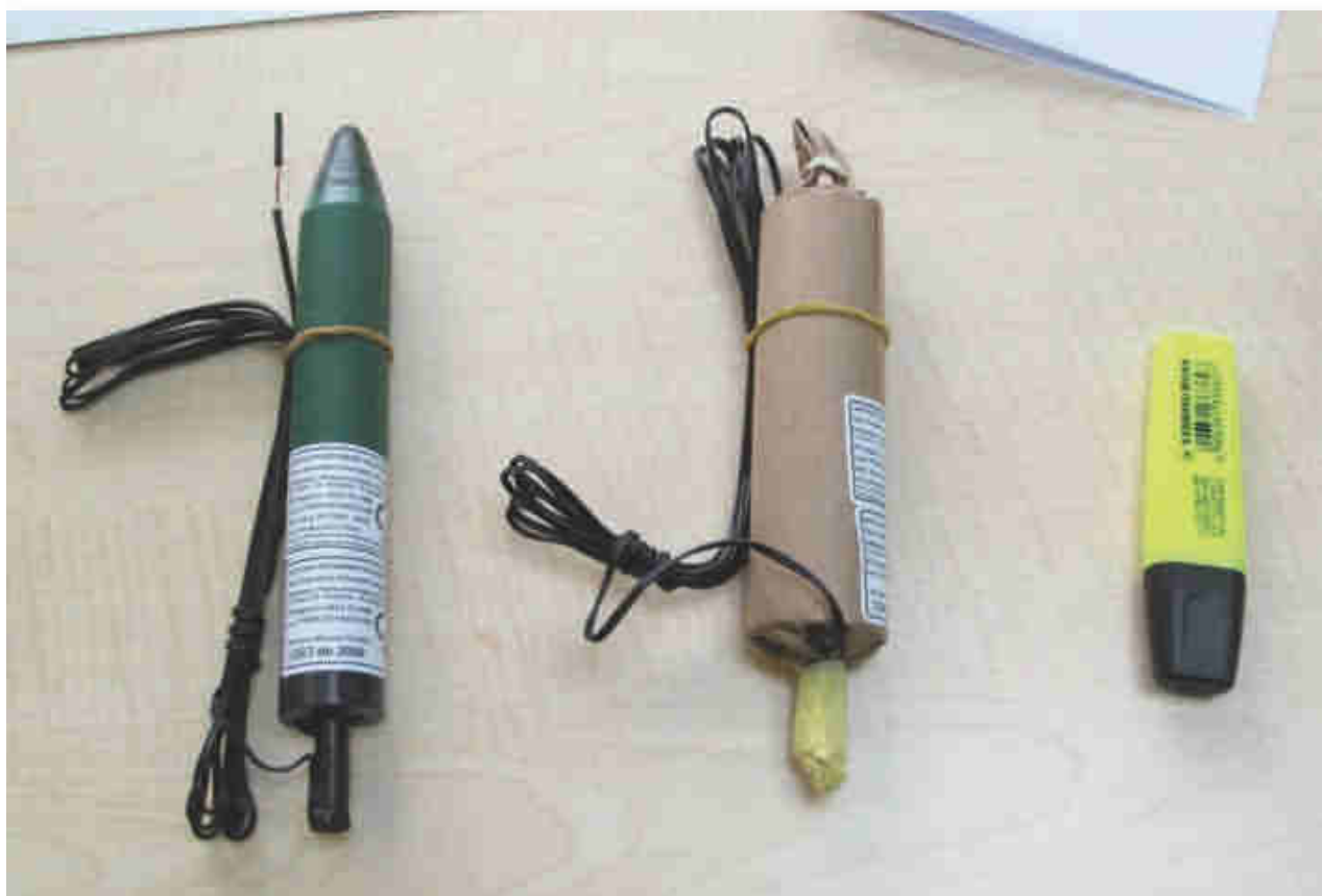
Les deux types de charges explosives utilisées par le Serpa pour la destruction des nids secondaires, de 60 g (à gauche) et 95 g (à droite).
